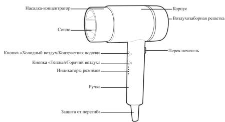
Чтобы включить фен, переведите *переключатель* в верхнее положение, чтобы выключить — в нижнее. По умолчанию устройство включается в режиме подачи теплого воздуха на низкой скорости, горит нижний белый индикатор режима.
