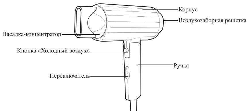
Чтобы включить прибор, переведите **переключатель** вверх в положение «1» (первая скорость работы и менее теплый воздух) или «2» (вторая скорость работы и более теплый воздух). Чтобы выключить фен, переведите переключатель вниз в положение «0».
