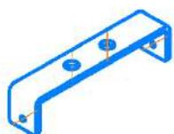
Скоба №2 крепится двумя болтами M10x20, на каждом болте одна шайба M10.
