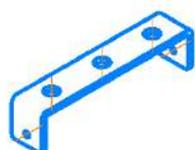
Скоба №3. Две крайние крепятся двумя болтами M10x20, на каждом из них по одной шайбе M10.
