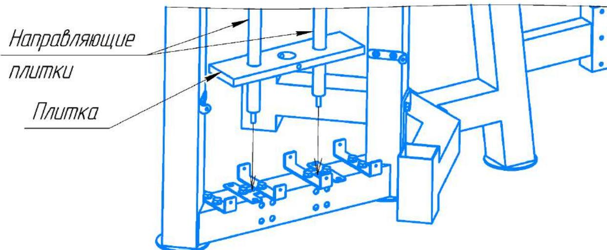
5.4. Зафиксировать направляющие плитки сверху рамы.
