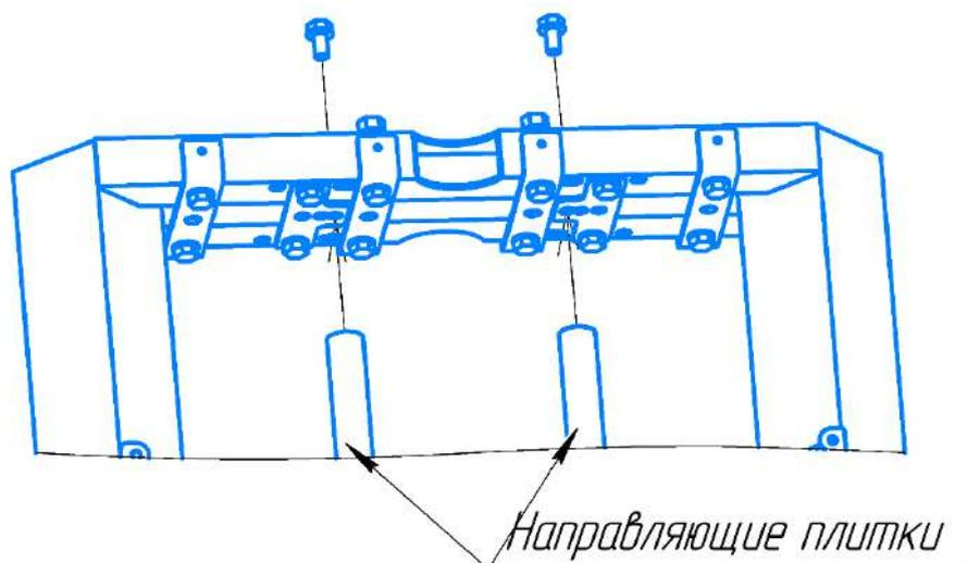
Направляющие плитки через отверстие в Т-скобе закрепить болтами M10x20, на каждом болте по одной шайбе M10.
