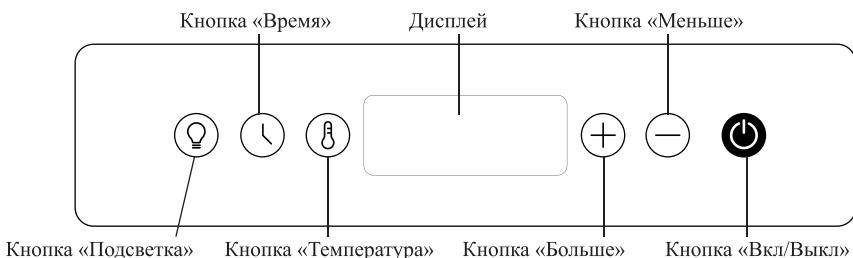
**Кнопка «Вкл/Выкл»** включает и отключает устройство.
