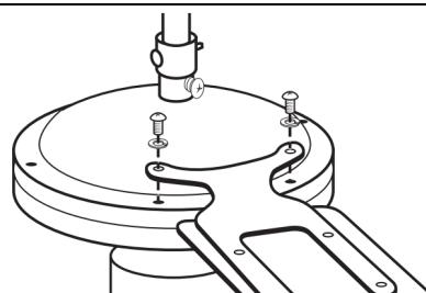
7. Закрепите лопасти вентилятора на корпусе с помощью винтов и шайб (в комплекте).
