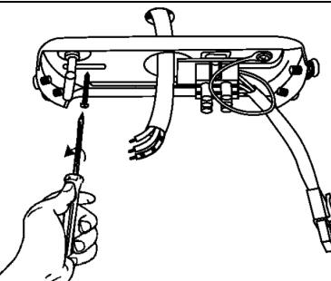
2. Просверлите два монтажных отверстия в потолке и надежно прикрепите монтажную пластину к потолку. Пропустите провода питания сквозь круглое отверстие в монтажной пластине.
