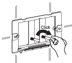
Вставьте толкатели в пластиковые гайки привода коромысел до упора и поверните на  $45^\circ$  по часовой стрелке до щелчка.
