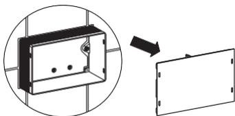
Фиксаторы в пазах отстегнуть при помощи отвертки.
