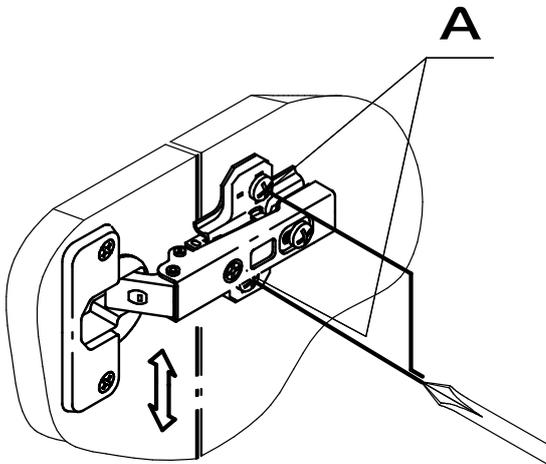
**б) Регулирование глубины**
