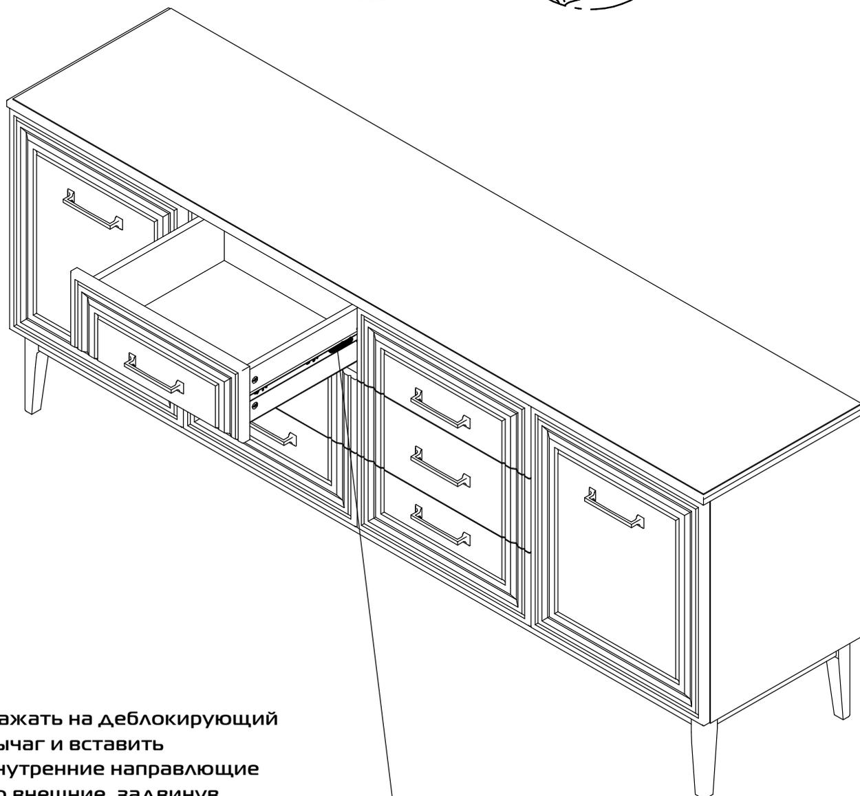
Нажать на деблокирующий рычаг и вставить внутренние направляющие во внешние, задвинув ящик до фиксации деблокирующим рычагом
