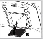
Монтаж: Вначала присоедините угольный фильтр к металлическим шпонкам в задней части вытяжки, затем в передней части, нажав на два рычажка.
