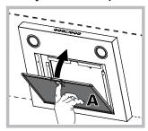
Жировой фильтр удерживает жирные частицы, содержащиеся в испарениях варочной панели при готовке. Необходимо чистить этот фильтр не реже одного раза в месяц неагрессивными моющими средствами вручную или в посудомоечной машине при низкой температуре по короткой программе. Для съема
