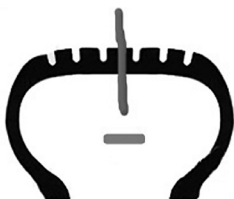
Неправильная установка жгута
