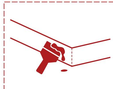
НАНОСИМ КЛЕЙ НА БОКОВОЙ КРАЙ УСТАНОВЛЕННОГО ПРОФИЛЯ,
