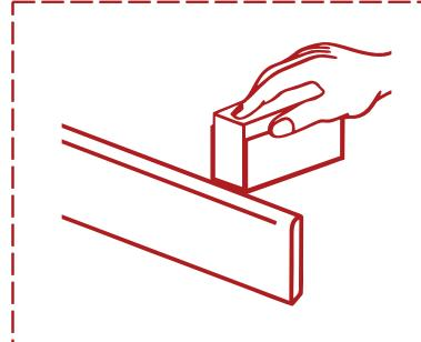
ПРОВЕРЯЕМ ТОЧНОСТЬ ПОДГОНКИ, ПРОТИРАЕМ ВЕТОШЬЮ
