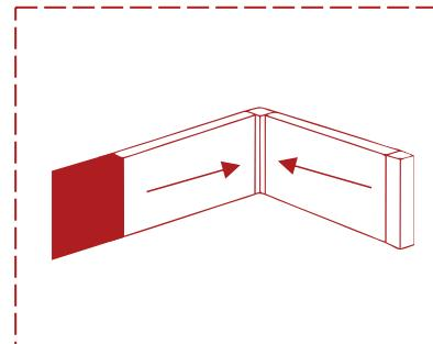
УДАЛЯЕМ ИЗЛИШКИ КЛЕЯ ПОСЛЕ НАНЕСЕНИЯ ПРОФИЛЯ
