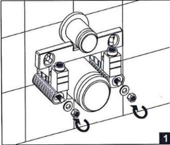
1. Установите крепеж к инсталляции согласно инструкции, прилагаемой к инсталляции.
