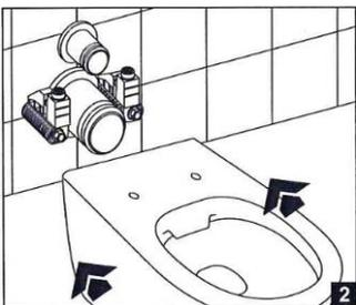
2. Закрепите унитаз к инсталляции и подключите изделие к системе водоснабжения.
