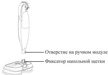
2. Рукоятку вставьте в удлинительную трубку так, чтобы фиксатор рукоятки попал в отверстие на трубке. У вас получится удлинительная ручка. Установите ее в ручной модуль так, чтобы выступы на ручном модуле попали в пазы удлинительной ручки, а рукоятка была направлена, как показано на втором рисунке ниже.
