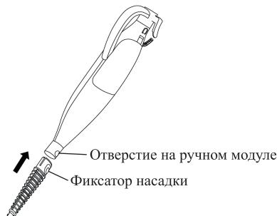
*Насадка для отпаривания с резиновым скребком, угловая насадка, скребок, плоская и круглые нейлоновые щетки* надеваются на струйную насадку. Присоедините одну из насадок к струйной насадке так, чтобы выступ на сопле струйной насадки попал в паз на выбранной насадке, и поверните насадку для фиксации. Чтобы отсоединить насадку от струйной насадки, поверните насадку и потяните в сторону от струйной насадки.
