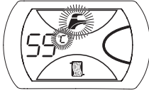
Рис. 5 Индикация настройки температуры ГВС
