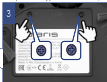
Батареялық бөлік қақпағының бұрамашегесін бұрап шығарыңыз және қақпақты шешіп алыңыз
