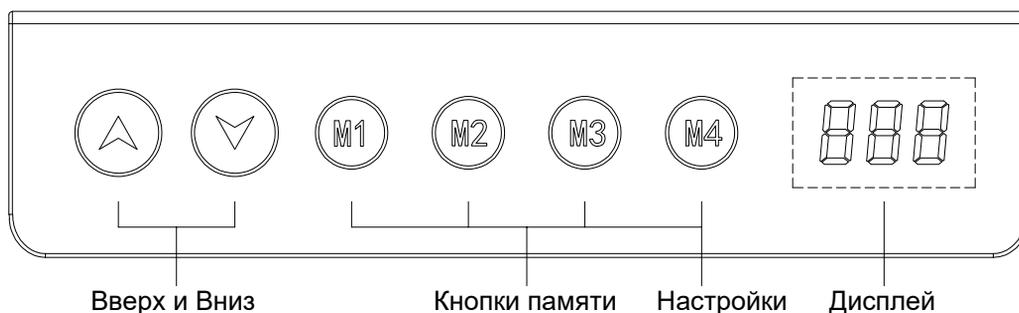
Управление осуществляется при помощи кнопок. Если пульт не используется в течение 30 секунд, экран и кнопки памяти блокируются. Для разблокировки используйте кнопки Вверх или Вниз. Когда дисплей подсвечен, пульт полностью разблокирован и готов к работе.
