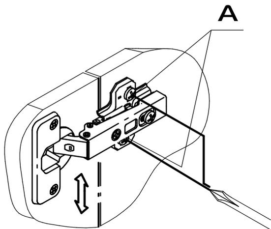
б) Регулирование глубины
