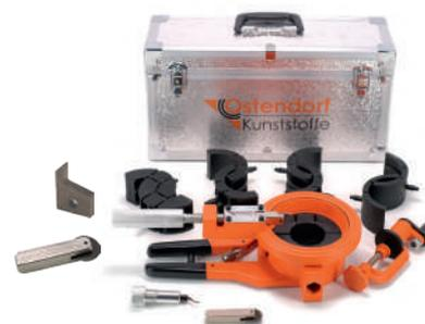
\* Базовый диаметр резака -110 мм. Дополнительные диаметры регулируются вставками, входящими в комплект. Для закрепления резака предусмотрена трубушина, идущая также в комплекте с инструментом. Инструмент и комплектующие упакованы в переносной кейс.
