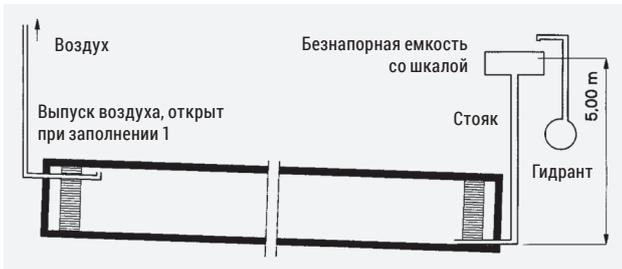
Между заполнением и испытанием трубопровода должно пройти достаточное время (1 час), чтобы оставшийся в трубопроводе после заполнения воздух мог постепенно выйти наружу.
