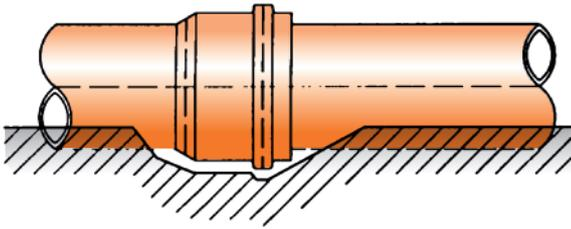
Опорная поверхность увеличивается при послойной засыпке и уплотнении рыхлым поддающимся уплотнению материалом, и опорный угол становится больше по сравнению с предварительно сформированным углом. Таким же образом можно укладывать трубу на ровное дно (тип основы 3), если опорная поверхность изготовлена подтрамбовыванием и уплотнением рыхлым способным утрамбовываться материалом и гарантировано, что боковая уплотненная засыпка будет как минимум такой же плотности, как и дно.
