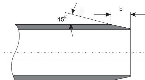
Фитинги нельзя укорачивать, т.к. иначе не будет обеспечена герметичность соединения.
