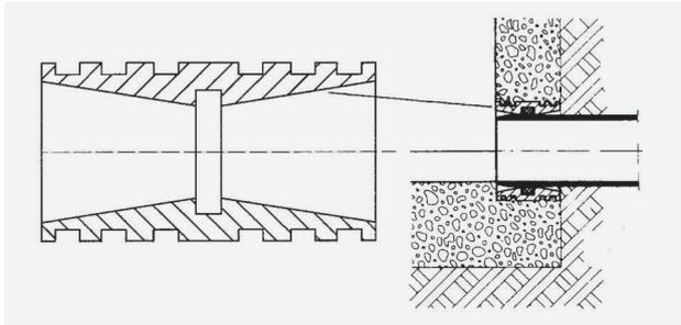
Гильзы прохода через стену применяются для входных и выходных труб, они устанавливаются внутри заподлицо со стенкой колодца и по завершении монтажа заливаются бетоном. Гильзы позволяют вставленной трубе отклоняться на 3°.
