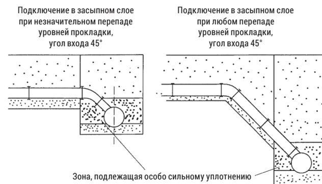
Если в силу местных условий нельзя избежать вертикального расположения трубопроводов, то рекомендуется подключение вывести сбоку между засыпной зоной и вершиной свода трубы. Соответствующий вертикальный канал заканчивается отводом. Фитинговую группу следует заделать в песок. Обратите внимание на область, подлежащую особенно тщательному уплотнению. Мы не советуем делать облицовку из бетона.
