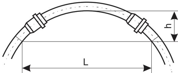
Трубы диаметром > DN 200 могут только немного изгибаться из-за высокой собственной жесткости)
