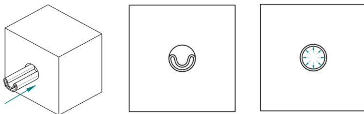
Рис. 5 Установка теплоизоляции в канал трубы
