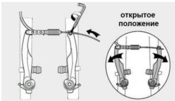
6. С силой нажмите на тормозную ручку и прижав колодки к ободу затяните гайки фиксации колодок.
