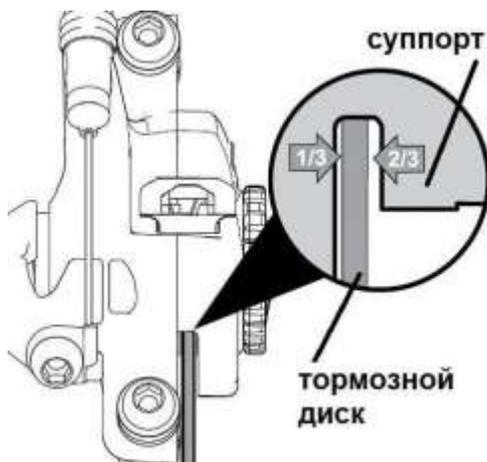
4. Установите и зафиксируйте тормозной трос на суппорте. Настройте положение неподвижной колодки.
