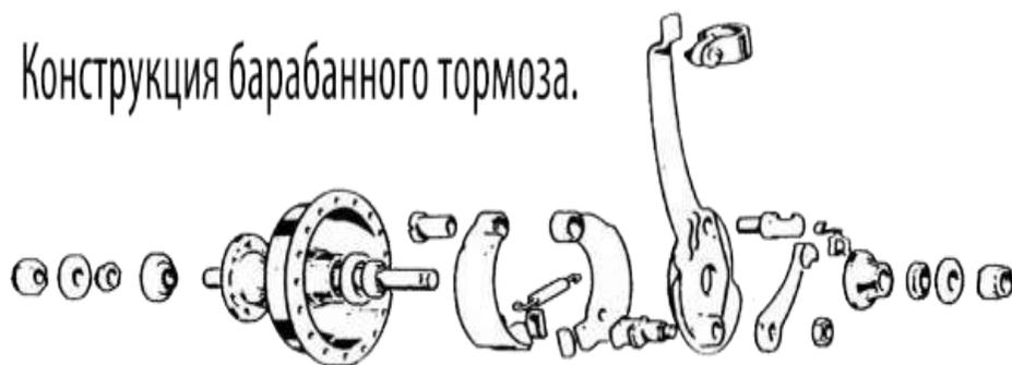
1. Открутите контргайку и снимите ее вместе со стопорной шайбой.
