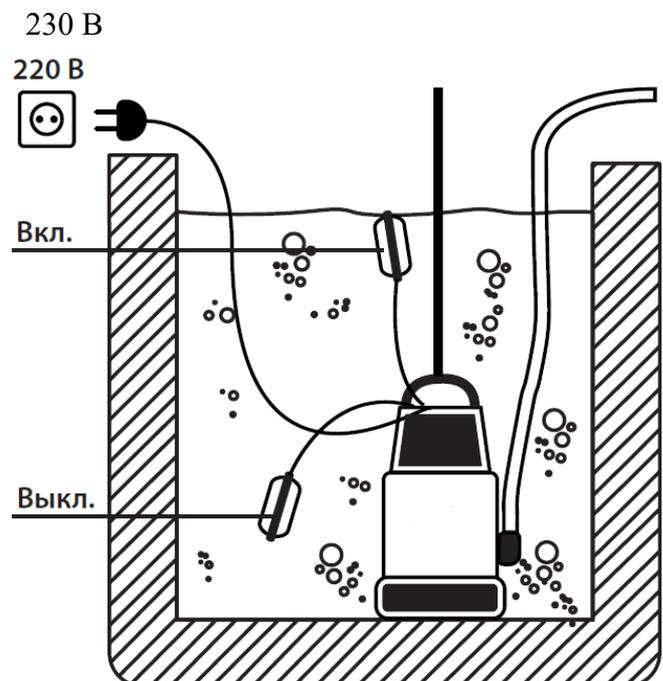
Необходимо удостовериться, что при минимальном уровне воды выключатель отключает насос. Убедитесь, что объем воды в пределах «Вкл.» и «Выкл.» поля регулирования по отношению к количеству перекачиваемой воды и не требует от насоса более 20 включений в час.
