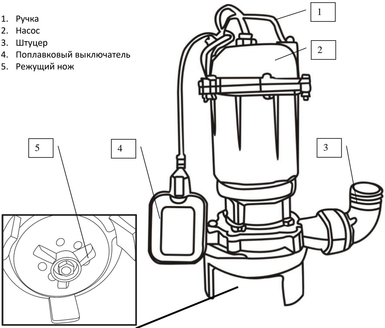
**ПРИМЕЧАНИЕ:** Режущий нож/измельчитель и поплавковый выключатель устанавливается не на все модели, смотрите технические характеристики.
