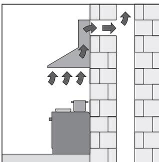
В режиме рециркуляции вытяжка не подключается к вентиляционной шахте, и, таким образом, воздух просто прогоняется через вытяжку внутри кухни.
