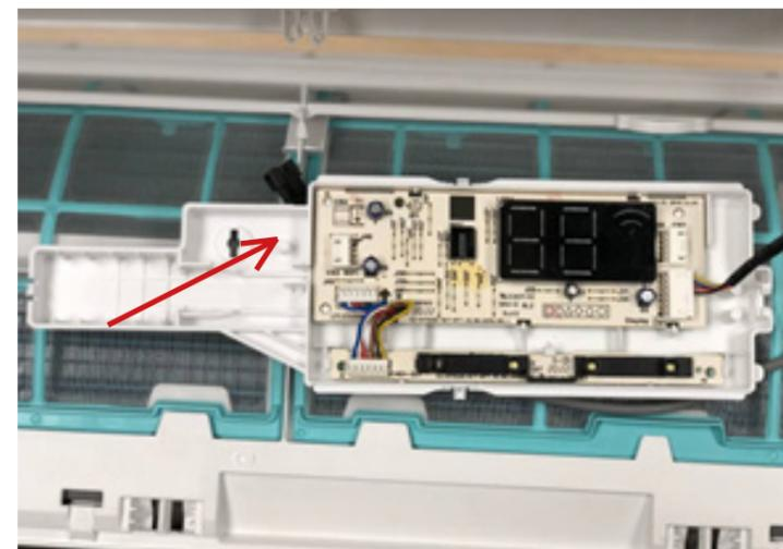
6. На фотографии представлен вид снятого дисплея. Стрелка показывает на разъем для кабеля подключения Wi-Fi модуля.
