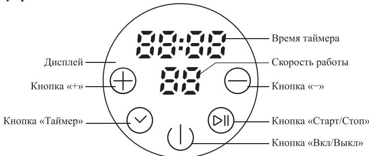
На **дисплее** сверху отображается время таймера в формате «ММ:СС», где ММ — минуты, а СС — секунды, а под временем — скорость работы.
