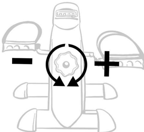
Чтобы увеличить нагрузку поверните регулятор по часовой стрелке и против для уменьшения нагрузки, соответственно.
