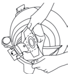
Установка бумажного мешка
