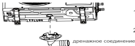
1. Подключите наружное дренажное соединение к отверстию на корпусе, как показано на рисунке ниже.
