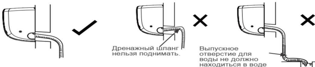
Наклоните дренажный шланг немного вниз. Дренажный шланг не может быть искривлен, поднят, изогнут и т. д.
