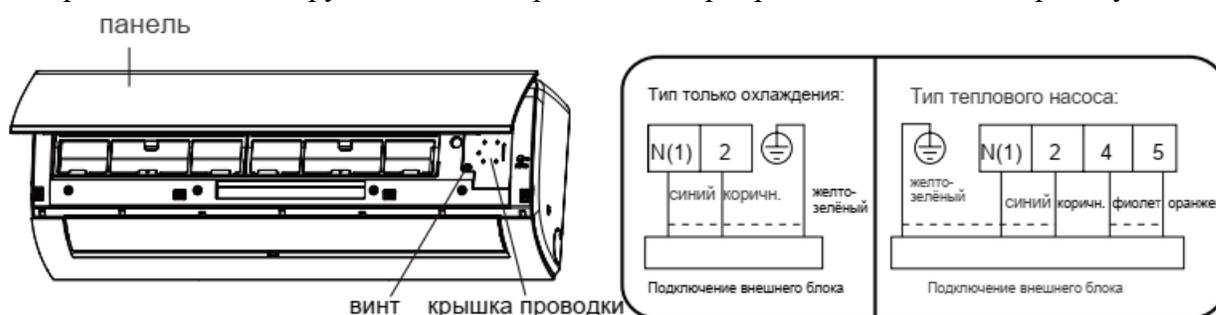
2. Сделайте так, чтобы шнур питания проходил через поперечное отверстие в задней части внутреннего блока, а затем вытяните его с передней стороны.
