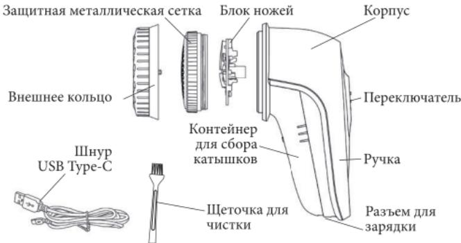
**Переключатель** включает и выключает устройство, а также переключает две скорости работы очистителя катышков. Всего у переключателя три положения:
