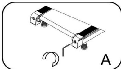
2. Если беговое полотно сместилось влево, выключите дорожку и поверните левый регулировочный болт на 1/4 по часовой стрелке, затем начните движение, чтобы проверить, отцентровано ли полотно или нет. Продолжайте регулировку до тех пор, пока полотно не будет отцентровано (рис. В).
