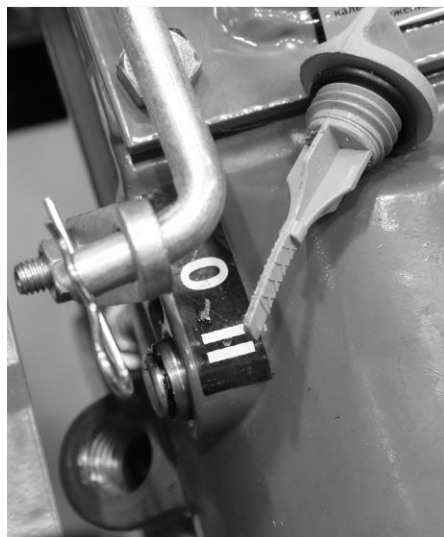
Рисунок 6 – Проверка уровня масла в корпусе редуктора
