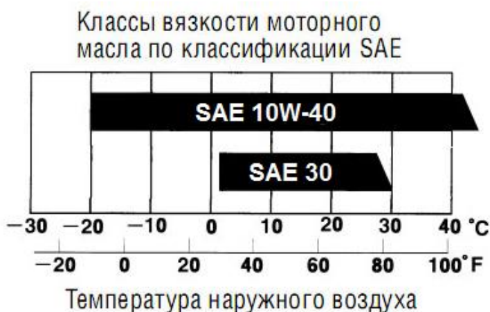
Рисунок 4 – Классы вязкости масла по классификации SAE
