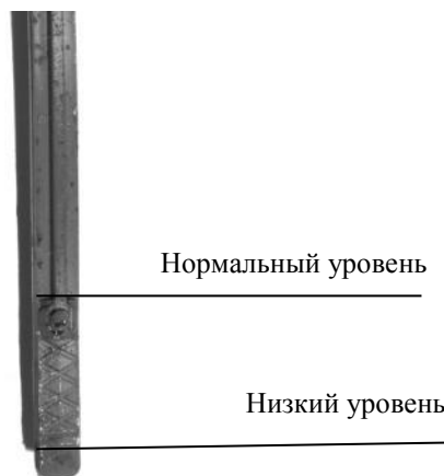
Рисунок 6 – Проверка уровня масла в корпусе редуктора
