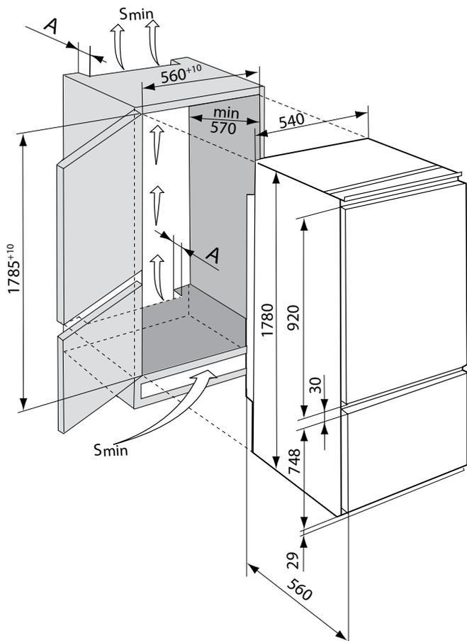
Рисунок 6 – Схема установки холодильника в меблі
