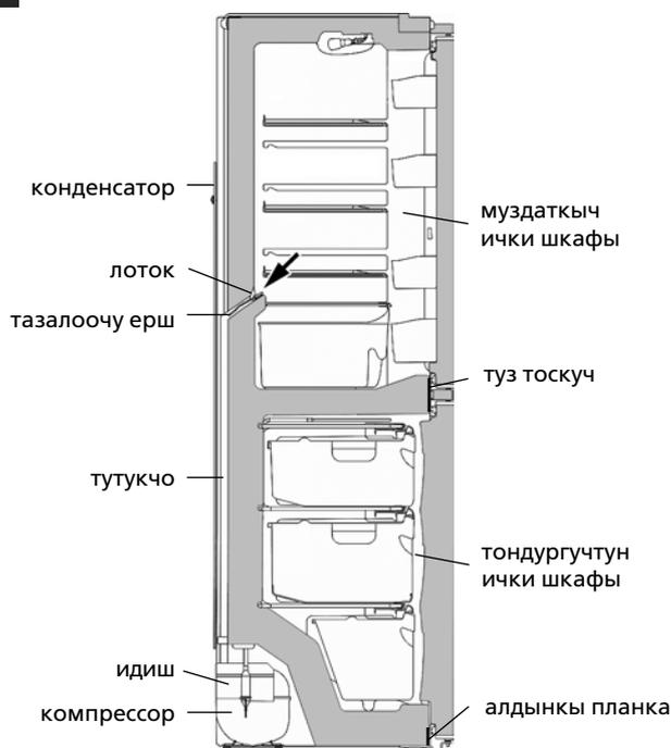
Сурет 10 – Эриген сууну тогуу системасынын схемасы
