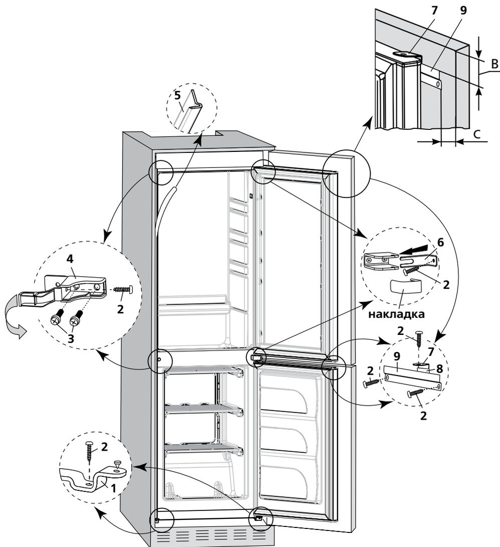
Рисунок 8 — Схема крепления холодильника к мебели
