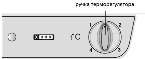
Рисунок 3 — Регулировка температуры
