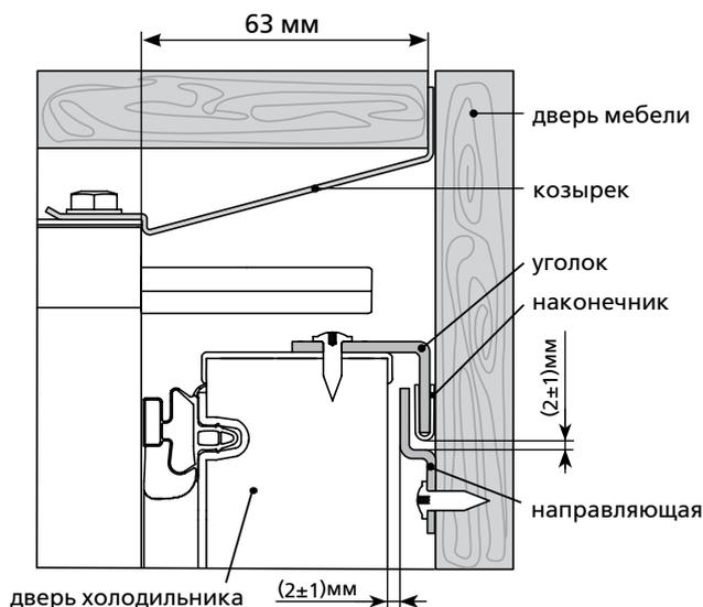
Рисунок 9 — Схема крепления дверей холодильника и мебели
