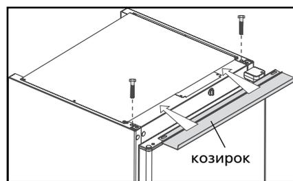
Рисунок 7 – Установка козирка
