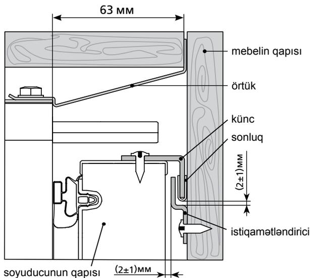
Şəkil 9 – Soyuducunun və mebelinin qapısının bərkidilməsi sxemi
