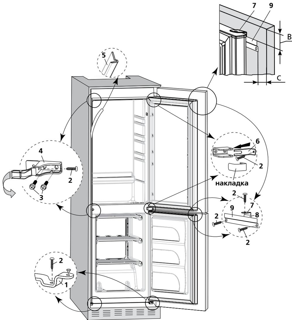
Рисунок 8 – Схема кріплення холодильника до меблів
