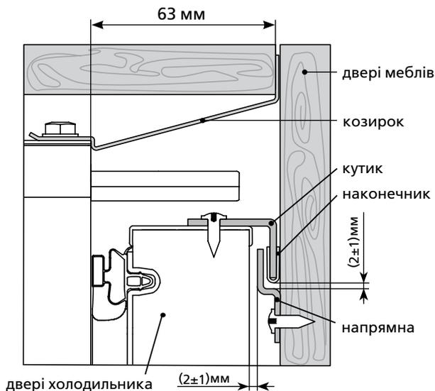
Рисунок 9 – Схема кріплення дверей холодильника і меблів
