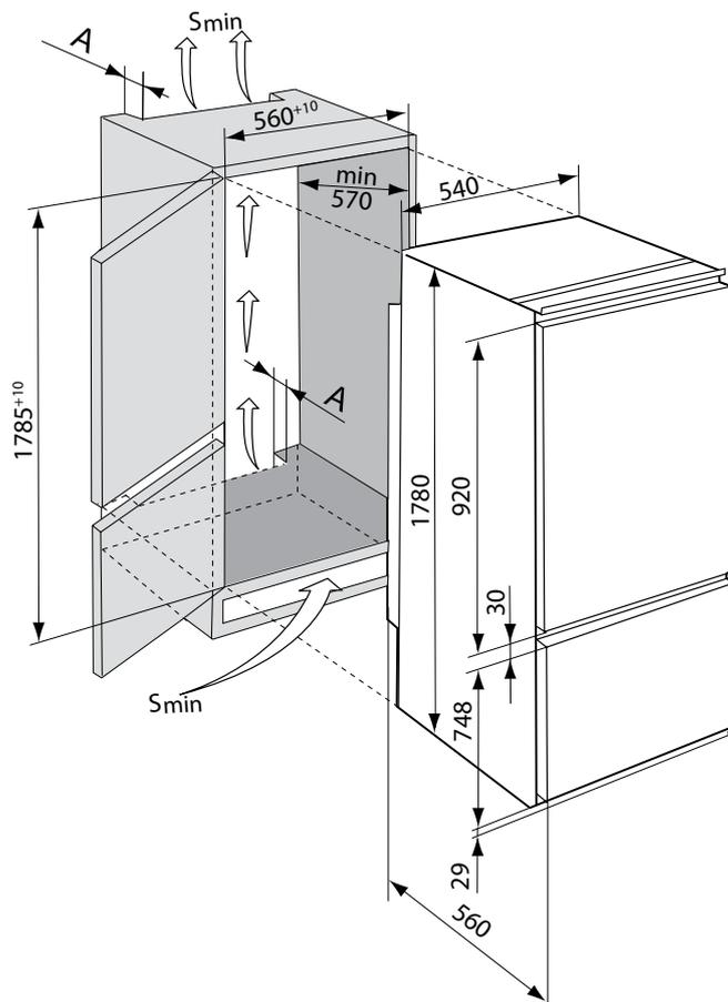
Рисунок 6 — Схема установки холодильника в мебель
