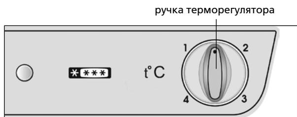
Рисунок 3 – Регулювання температури
