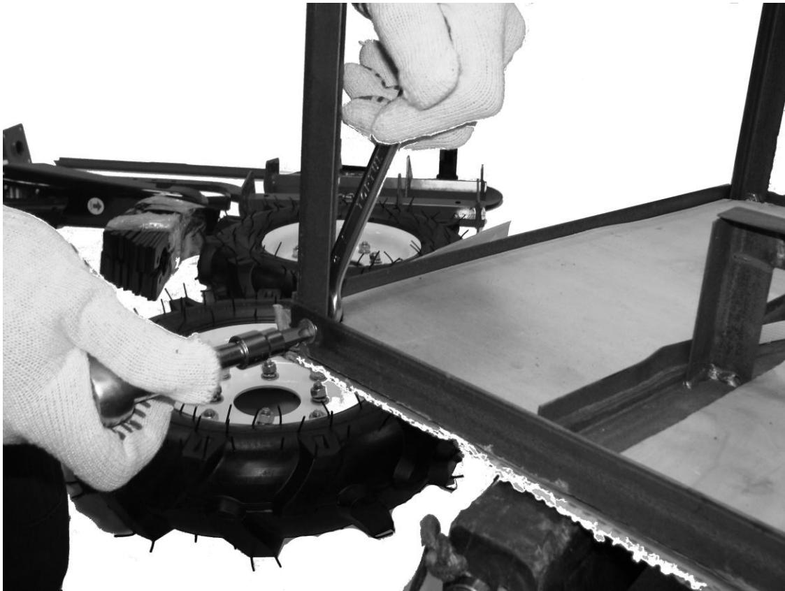
Начните сборку с колес. Выкрутите из каждого колеса по четыре ближних к центру болта . Возьмите валы и прикрутите их к колесам, используя ключ на и выкрученные ранее болты . Обратите внимание, что колеса имеют направленный протектор.
