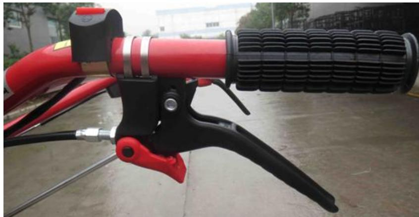
**4. Переведите рычаг переключения в нейтральное положение. Это среднее положение между первой и второй передачами (стрелка N на рисунке).** Если Вы впервые сталкиваетесь с подобной системой переключения - опробуйте все режимы. Включение передачи сопровождается характерным «зашелкиванием» рычага в передачу. Переключение между движением вперед и назад также должно происходить с выжимом сцепления.
