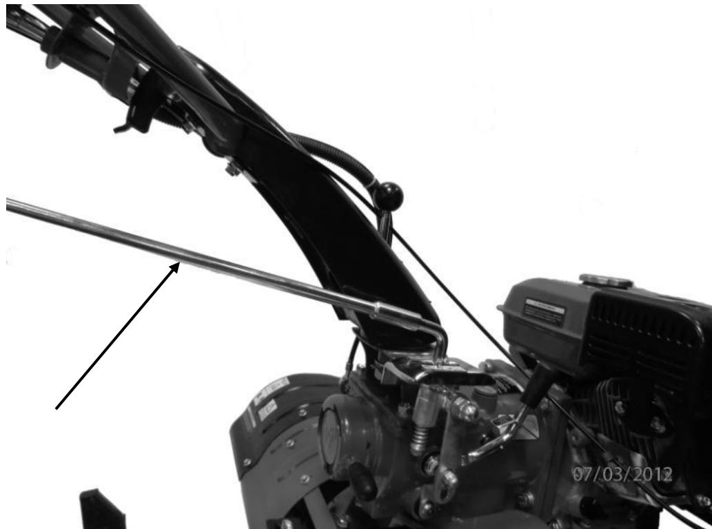
Выберите люфты в тросиках сцепления и газа. Для этого используйте резьбовые втулки с контргайками на концах тросов (для троса газа может быть в середине). Выжим сцепления должен быть четкий, Вы должны чувствовать, что преодолеваете сопротивление пружины механизма сцепления.
