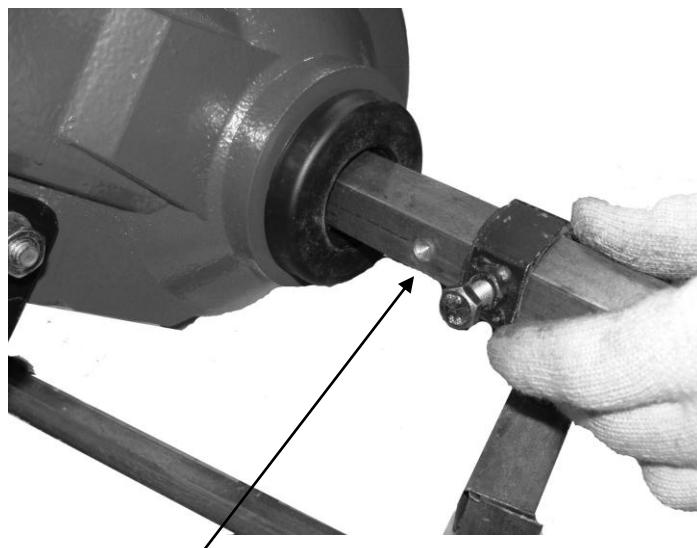
Установите крепление защитных шайб. Болты должны попасть в углубления на выходном валу .
