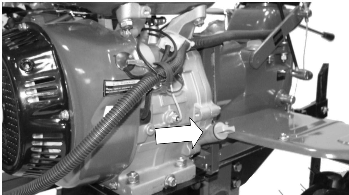
Если из-под бензобака висит черный провод с разъемом на конце - найдите в проводке ответный черный провод и соедините их.
