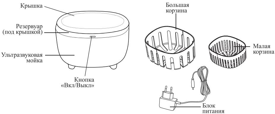
**Кнопка «Вкл/Выкл»** включает и выключает ультразвуковую мойку. Время работы — 5 минут, по истечении 5 минут ультразвуковая мойка отключается.
