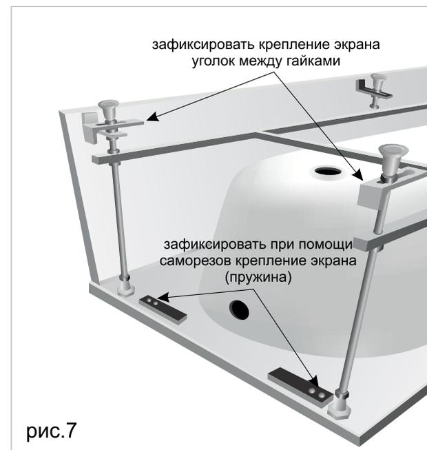
С лицевой стороны экрана фиксируем панель шурупами (на шуруп зафиксировать основание для декоративного колпачка) в нижней части к креплению экрана уголок. Установить декоративную заглушку, установка завершена.
