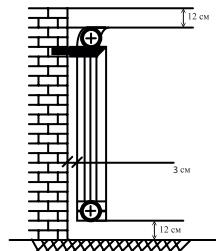
4.11. а) В период между отопительными сезонами, а также в случае необходимости, рекомендуется отключить радиатор от системы отопления. Поскольку отопительная система должна быть заполнена теплоносителем в течение всего периода эксплуатации, требуется проводить отключение в следующей последовательности: сначала отключить клапан обратной подводки, затем клапан подающей подводки, после чего открыть клапан выпуска воздуха;
