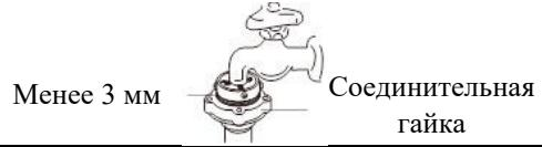
Чтобы отсоединить шланг подачи воды, пожалуйста, нажмите на стопорное кольцо шланга подачи воды.
