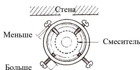
Прижмите верхнюю часть к горловине крана так, чтобы уплотнительное кольцо полностью соприкасалось с краном (пожалуйста, не вынимайте уплотнительное кольцо).
