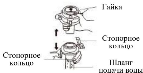
Ослабьте четыре крепежных винта на верхней части разъема и поверните нижнюю часть разъема, чтобы оставить достаточное расстояние для установки винтов между верхней и нижней частями разъема.
