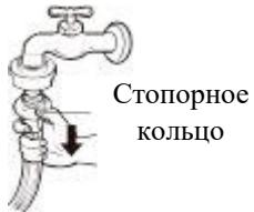
Чтобы установить шланг подачи воды, пожалуйста, поверните стопорное кольцо шланга подачи воды назад, чтобы освободить его.
