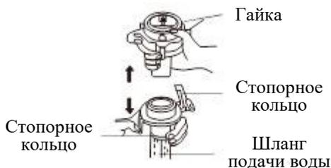
Ослабьте четыре крепежных винта на верхней части разъема и поверните нижнюю часть разъема, чтобы оставить достаточное расстояние для установки винтов между верхней и нижней частями разъема.
