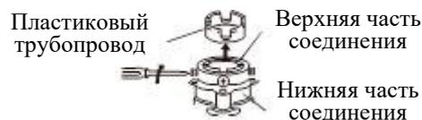
Равномерно отрегулируйте четыре винта соединителя так, чтобы два винта у стены сначала полностью соприкоснулись с внешней поверхностью крана.
