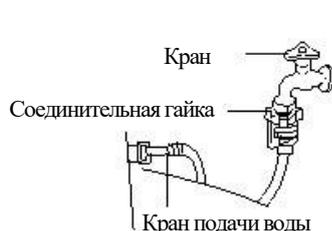
погрузите шланг в горячую воду с температурой примерно 50°C.
