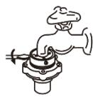
Поверните нижнюю часть разъема, чтобы плотно завинтить его (в противном случае из соединения может вытекать вода). После поворота зазор между нижней частью и верхней частью соединителя должен быть меньше 3 мм.
