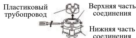
Равномерно отрегулируйте четыре винта соединителя так, чтобы два винта у стены сначала полностью соприкасались с внешней поверхностью крана.
