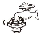
Поверните два винта (см. рисунок) напротив стены так, чтобы они соприкасались с краном, и плотно завинтите их отверткой.
