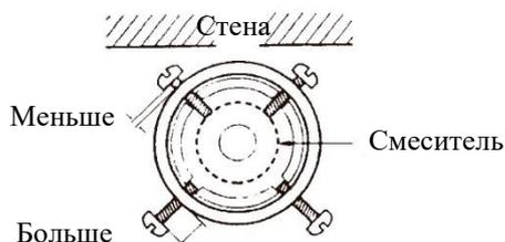
Прижмите верхнюю часть к горловине крана так, чтобы уплотнительное кольцо полностью соприкасалось с краном (пожалуйста, не вынимайте уплотнительное кольцо). Пожалуйста, используйте стандартный кран, горловина крана должна быть гладкой.
