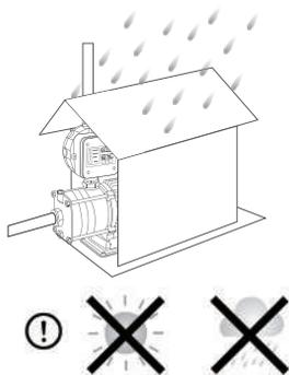
Насос должен быть установлен в удобном для обслуживания месте. Оптимальная установка насоса изображена на рисунке.
