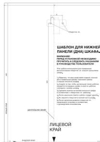
Отметьте расположение отверстий на дне шкафа в соответствии с отметками «А» на шаблоне.
