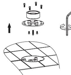
1. Схема базы для установки напольного смесителя.
