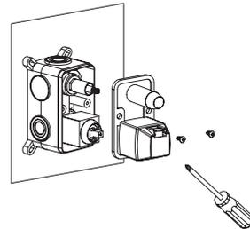
1. Монтируйте корпус смесителя на необходимой высоте (обычно ~900-1200 мм от пола) и подключите трубы подвода и вывода воды согласно отметкам на смесителе.
