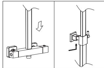
7. Просверлите отверстия и установите анкера. Установите монтажную часть, используя герметик.
