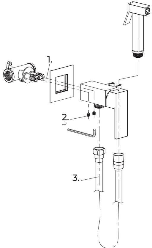
1. Плотно закрепите корпус, крышку и клапан на стене.
