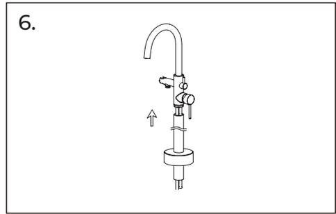
5. Соберите корпус с помощью винтового инструмента, установите декоративную крышку на трубу, затяните впускную трубу в корпус шестигранным ключом.
