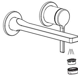
5. Установите декоративную крышку на стену, а затем с помощью шестигранного ключа установите ручку.
