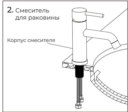
1. Убедитесь, что в умывальнике или столешнице имеется отверстие диаметром 35 мм.
