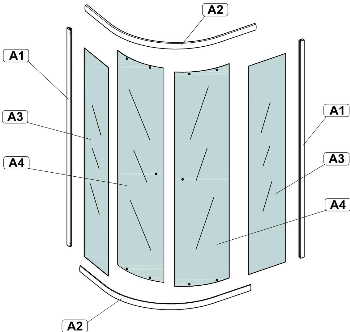
Алюминиевые детали изделия могут иметь незначительные изменения геометрии, перед началом сборки приложите их к душевому поддону и при необходимости произведите регулировку радиуса, так чтобы он совпадал со скругленной частью борта (радиусом) поддона.
