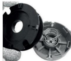
Возьмите отрезок лески длиной 5 – 5,5 метров, сложите его пополам. Вставьте петлю лески в паз посередине катушки. Намотайте леску на катушку в два ручья. Направление намотки лески указано стрелкой на корпусе катушки.
