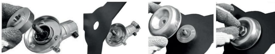
Гайканы қатайту үшін алтыбұрышты кілтті пайдаланып, білікті тісті беріліс корпусындағы арнағы тесік пен гайка кілті арқылы бекітіңіз. Гайканың сол жаққа бұралады.
