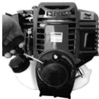
Слегка потяните за ручку стартера до момента входа элементов стартера в зацепление с валом двигателя, что будет ощущаться как появившееся сопротивление движению троса стартера. После этого резко потяните ручку стартера. Если вспышка в двигателе не произошла с первого раза, нужно повторить (возможно, несколько раз) процедуру рывка до тех пор, пока не услышите в двигателе первую вспышку.
