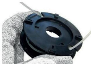
Усталюеце катушку ў корпус галоўкі, папярэдне заправіўшы канцы лёскі ў выходныя адтуліны на корпусе галоўкі.
