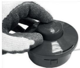
Совместите выступ корпуса головки с пазом в крышке головки. Нажмите на крышку головки и не отпуская поверните ее в направлении «OFF».
