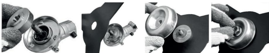
Для зацягвання гайкі выкарыстоўвайце шасцігранны ключ для фіксацыі вала праз адмысловую адтуліну ў корпусе рэдуктара і ключ для гайкі. Гайка мае левае разъбярства.
