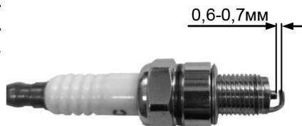
После обслуживания свечи зажигания установите ее в обратной последовательности.
