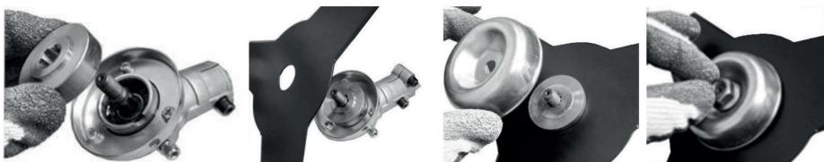
Для затягивания гайки используйте шестигранный ключ для фиксации вала через специальное отверстие в корпусе редуктора и ключ для гайки. Гайка имеет левую резьбу.
