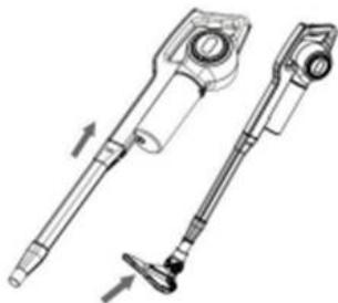
Установите удлинительную трубку и напольную щетку к корпусу пылесоса
