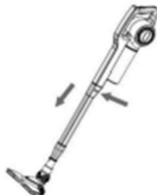
Для отсоединения удлинительной трубки от пылесоса, нажмите на кнопку на удлинительной трубке, которая находится на задней стороне корпуса пылесоса, и потяните за трубку
