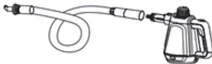
Если вы планируете обрабатывать горячим паром труднодоступные места, присоедините к патрубку прибора удлинительный гибкий шланг. Для этого наденьте гибкий шланг на патрубков и прижмите до щелчка.
