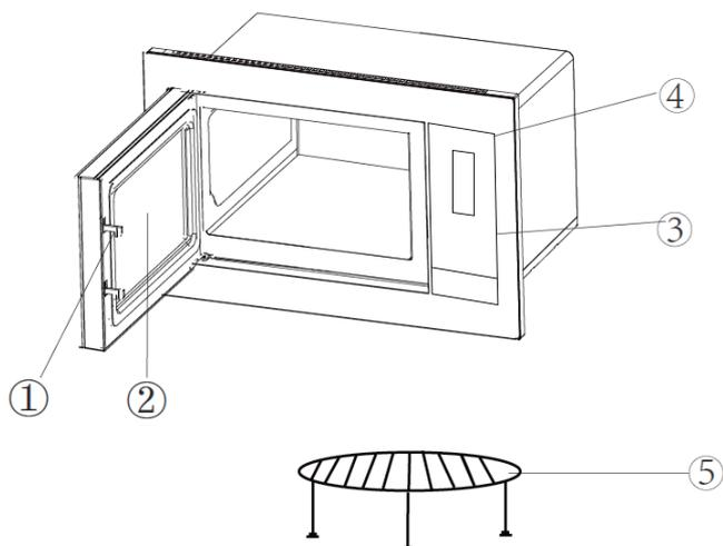
1 – Система безопасности дверного замка
