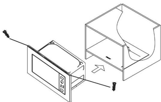
1. Поместите микроволновую печь в специальный отсек кухонной мебели, в горизонтальном направлении и соблюдайте расстояние между краями с двух сторон одинаковым. Затем закрепите микроволновую печь с помощью винтов (Винт (2x22)) на верхней части прибора.
