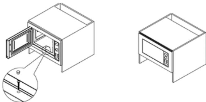
2. Откройте дверцу и закрепите микроволновую печь с помощью еще одного винта (Винт (1x35)) в специальном отверстии, затем установите заглушку.
