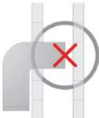
Fig.7 b. Conexión del tubo ondulado de plástico
