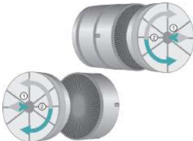
Fig. 14 Instalación del filtro de carbono
