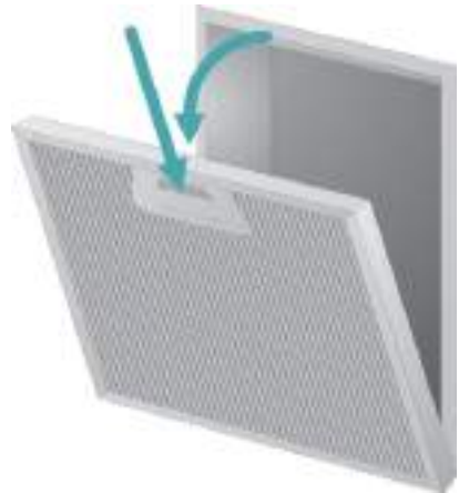
Fig. 12 Extracción del filtro antigrasa de aluminio
