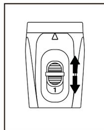
AD-18M) - при высоком числе оборотов/меньшее значение крутящего момента, больше подходит для режима сверления и откручивания/закручивания небольшого крепежа.
