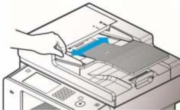
**2** Продвиньте оригинал сканируемой стороной вверх до упора.
