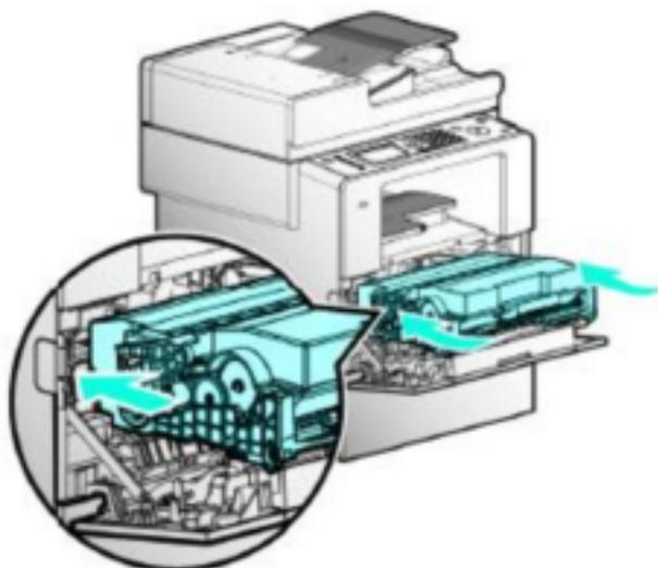
**3** Закройте переднюю крышку. Убедитесь, что оба боковых конца крышки защелкнулись. В противном случае устройство может работать неправильно.
