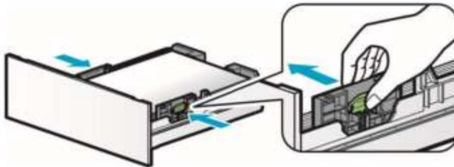
10 Вставьте лоток обратно по направляющим и задвиньте его до упора.
