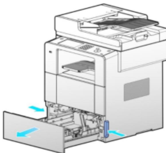
**2** Удерживая стопор направляющих (ограничителей) ширины и направляющие (ограничители) ширины, раздвиньте или сдвиньте их так, чтобы они соответствовали ширине бумаги.
