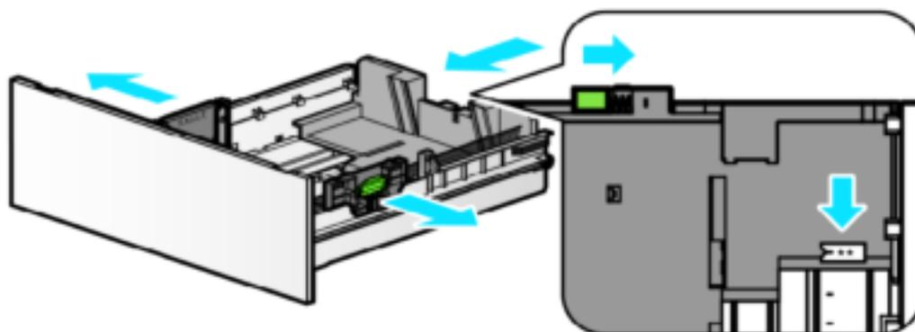
**4** Закрепите стенку ограничителя длины в соответствии с выбранным форматом бумаги. Положение для фиксации указано на внутренней нижней стороне лотка.
