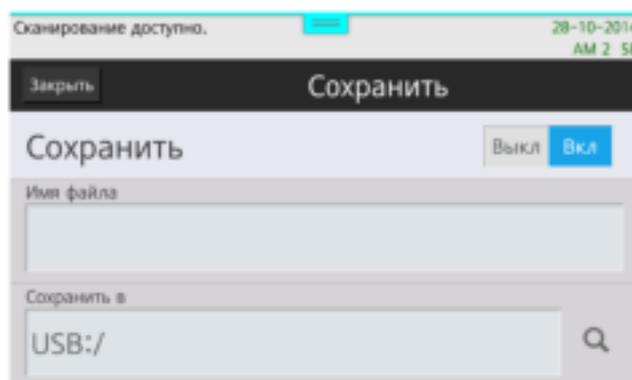
6 При необходимости установите **Разрешение**, **Размер оригинала**, **Тип оригинала** и тип файла кнопкой **Сохранить как**.
