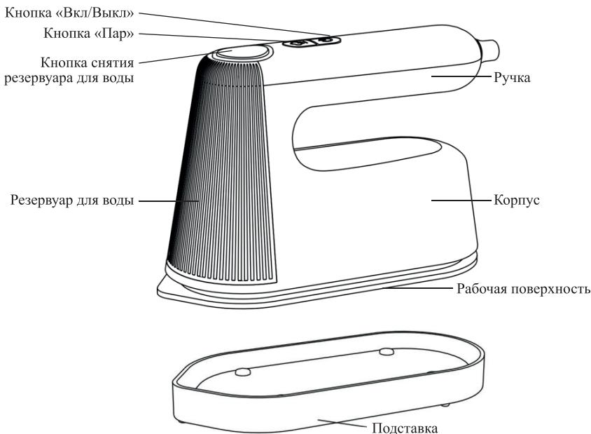
Отпариватель оснащен помпой (водяным насосом). Вода из резервуара подкачивается помпой в бойлер, где испаряется. Пар выходит через паровые сопла на рабочей поверхности. Помпа позволяет точно дозировать количество подаваемой в бойлер воды и получать устойчивую подачу пара.
