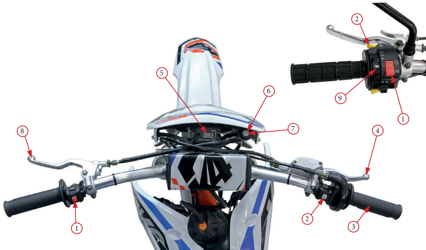
Фото 2.3. Приборы и органы управления: 1 – кнопка выключения двигателя; 2 – кнопка стартера; 3 – рукоятка акселератора; 4 – рычаг переднего тормоза; 5 – счетчик моточасов (приборная панель); 6 – замок зажигания; 7 – рычаг сцепления; 9 – переключатель фары (ближний/дальний свет)
