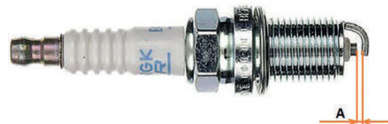
Фото 5.16. Зазор между электродами свечи зажигания
