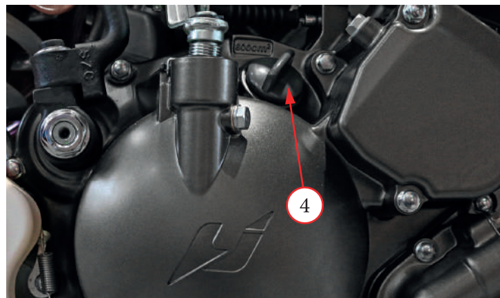
Фото 5.1.1. Исполнение смотрового окна и крышки горловины двигателей
