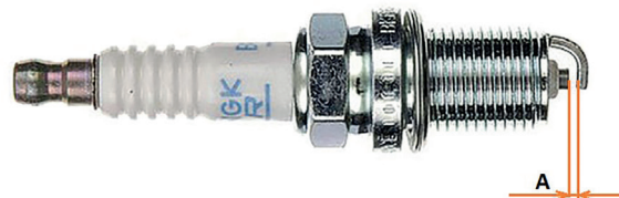
Фото 5.16. Зазор между электродами свечи зажигания
