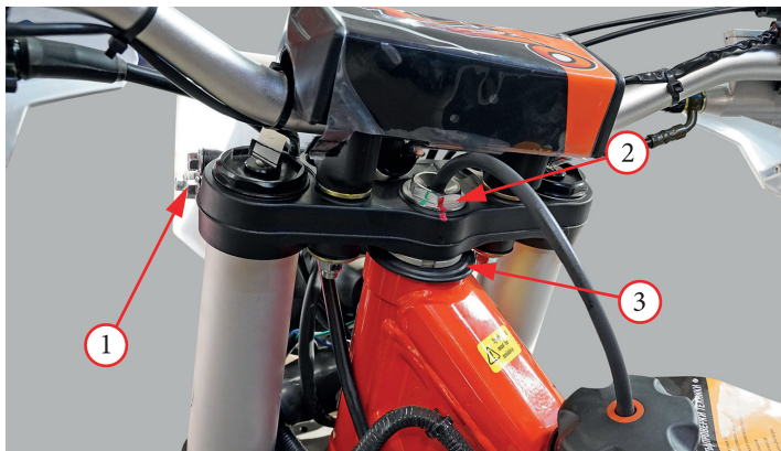
Фото 5.33. Регулировка подшипников рулевой колонки
