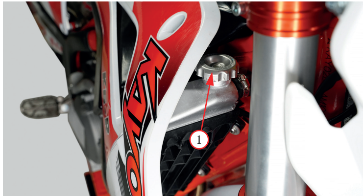
Фото 5.6. Контроль уровня охлаждающей жидкости
