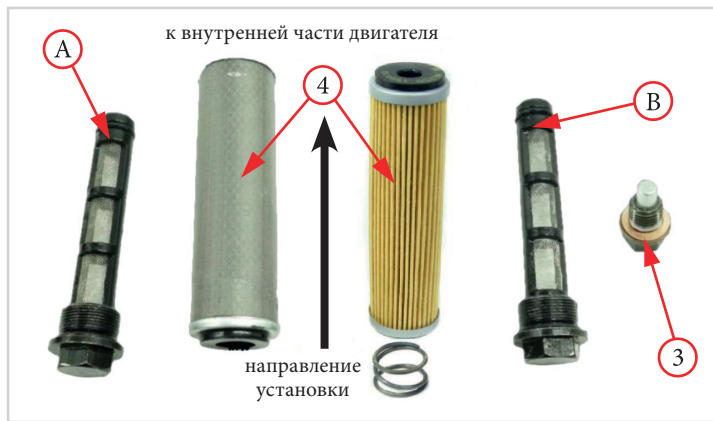
Фото 5.4.1. Замена масла в двигателях с масляным фильтром
