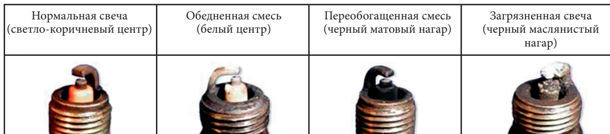
Фото 5.15. Состояния свечей зажигания
