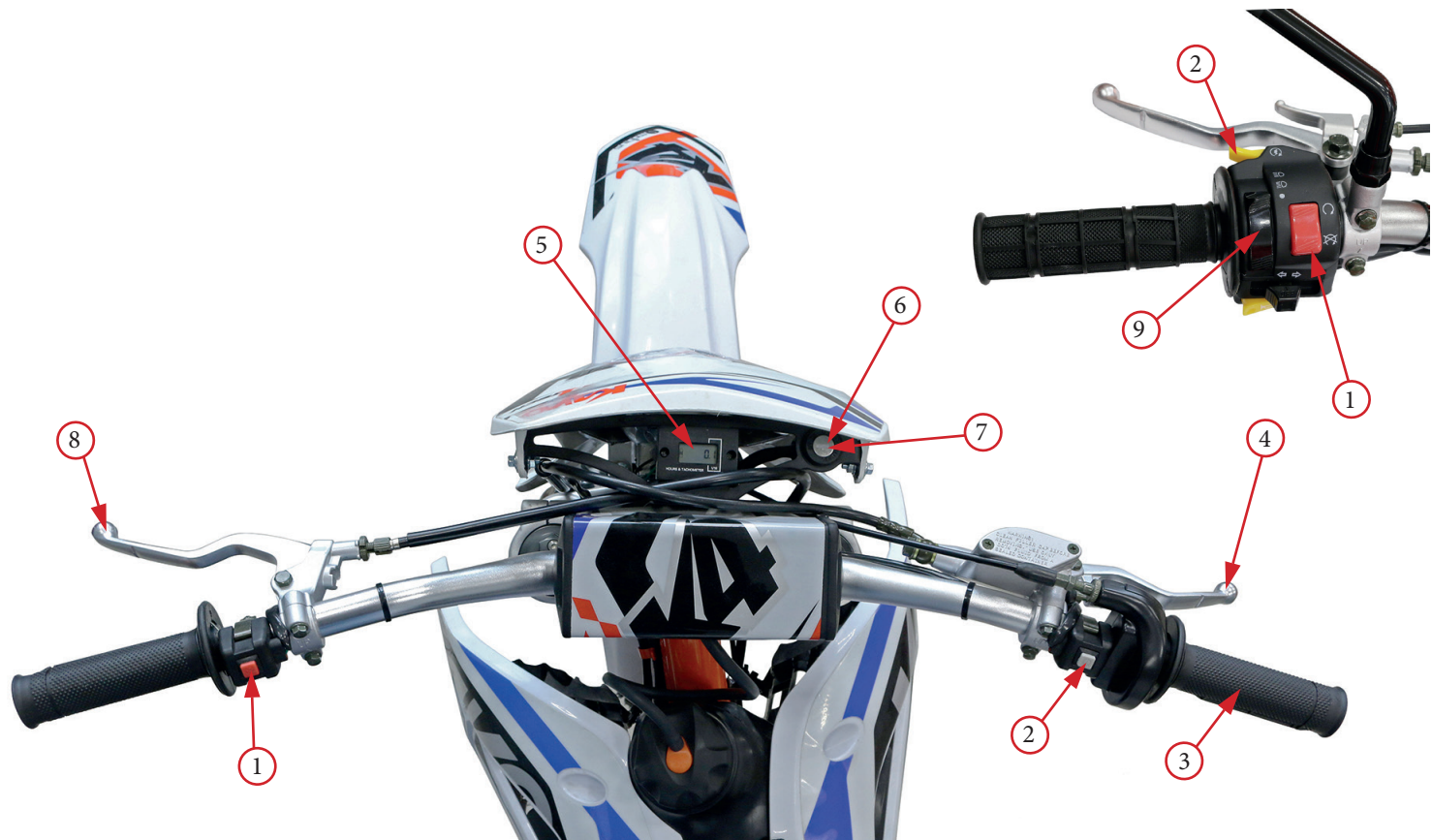
Фото 2.3. Приборы и органы управления: 1 – кнопка выключения двигателя; 2 – кнопка стартера; 3 – рукоятка акселератора; 4 – рычаг переднего тормоза; 5 – счетчик моточасов (приборная панель); 6 – замок зажигания; 7 – рычаг сцепления; 8 – цилиндр переднего тормоза; 9 – переключатель фары (ближний/дальний свет)
