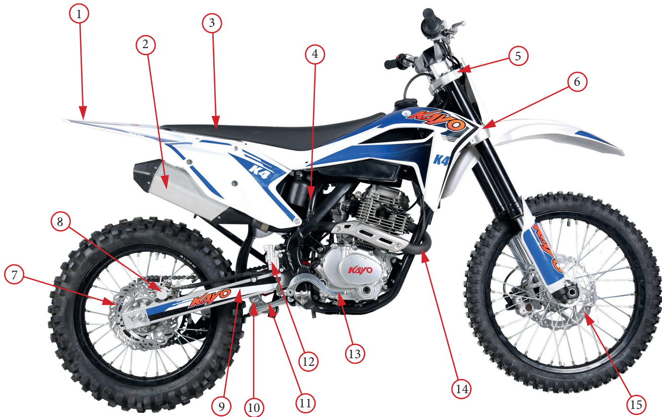
Фото 2.2. Правая сторона мотоцикла: 1 – заднее крыло; 2 – глушитель; 3 – сиденье; 4 – задний амортизатор; 5 – верхний зажим; 6 – нижний зажим; 7 – тормозной диск заднего тормоза; 8 – задний тормозной суппорт; 9 – маятник; 10 – треугольное коромысло; 11 – U-образное коромысло; 12 – задний тормозной цилиндр; 13 – педаль заднего тормоза; 14 – выхлопной патрубков; 15 – диск переднего тормоза
