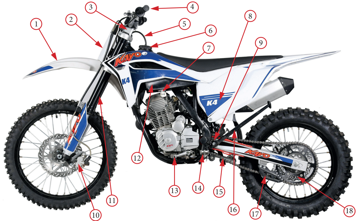
Фото 2.1. Левая сторона мотоцикла: 1 – переднее крыло; 2 – передний щиток; 3 – верхняя траверса; 4 – руль; 5 – вентиляционная трубка; 6 – крышка бака; 7 – топливный кран; 8 – крышка доступа к воздушному фильтру; 9 – крышка направляющей цепи; 10 – передний тормозной суппорт; 11 – передняя вилка; 12 – топливный бак; 13 – рычаг переключения передач; 14 – левая подножка водителя; 15 – цепь; 16 – боковая подставка; 17 – направляющая цепи; 18 – задняя звездочка
