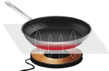
Индукционный нагрев обеспечивается электромагнитным полем. Индукционная катушка внутри плитки создает электромагнитное поле, которое вызывает нагрев посуды, стоящей на поверхности плитки. Исходя из природы процесса нагрева, существуют требования к посуде, применяемой для индукционных плиток. Во время нагрева индукционная плитка может создавать определенные шумы:
